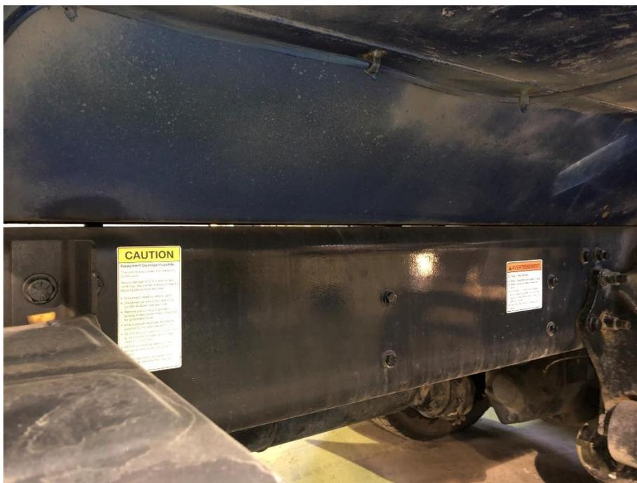
2. Choisir l'un des 2 supports fournis selon le type de benne avec laquelle vous travaillez. Les supports peuvent être modifiés pour s'adapter plus facilement à la benne. S'assurer qu'il n'y a rien de l'autre côté pour obstruer le perçage.
