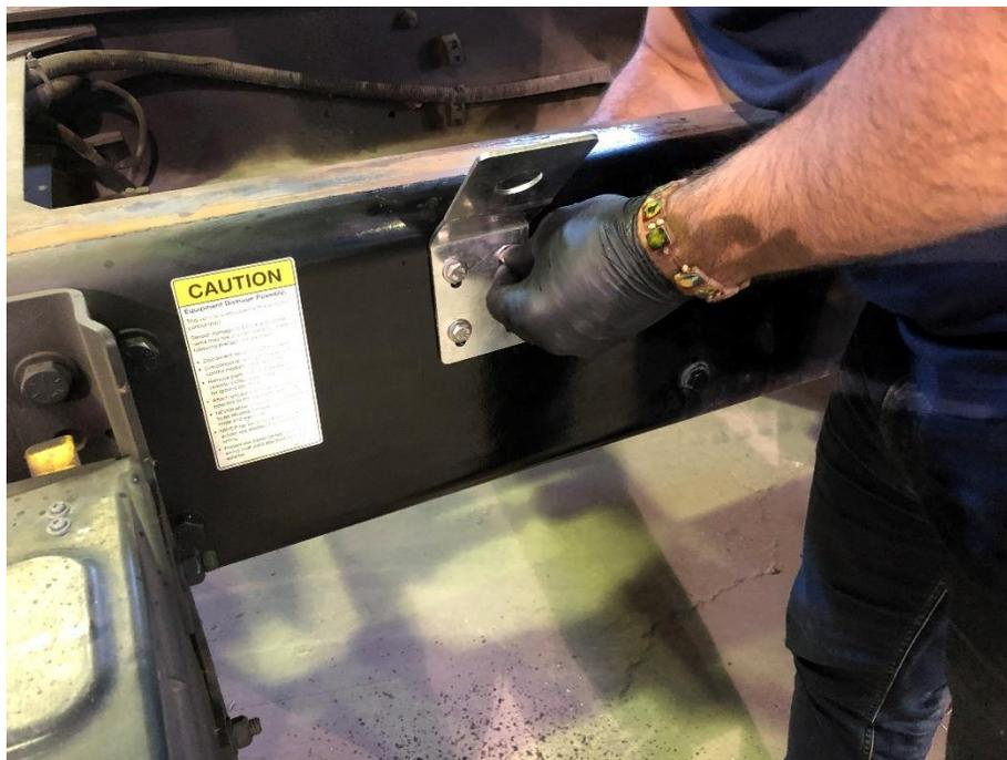
7. Mettre le capteur en place.
