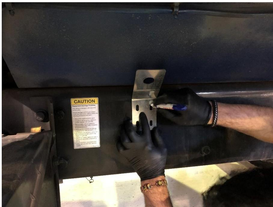
5. À l'aide d'une mèche 5/16" percez le châssis du camion. (N. B. Il est strictement interdit de percer près du rayon ou sur la face du dessus du châssis. Veuillez-vous référer aux indications du manufacturier pour le dégagement acceptable avant de percer.
