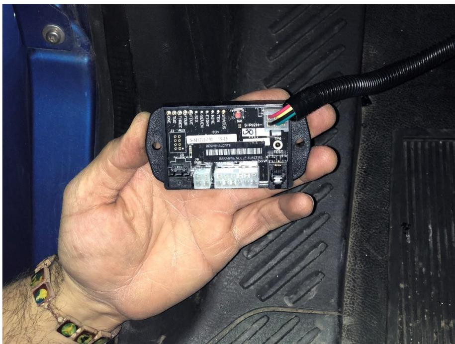
3. Brancher le connecteur principal, composé du connecteur 12 positions et du connecteur 4 positions noir.
